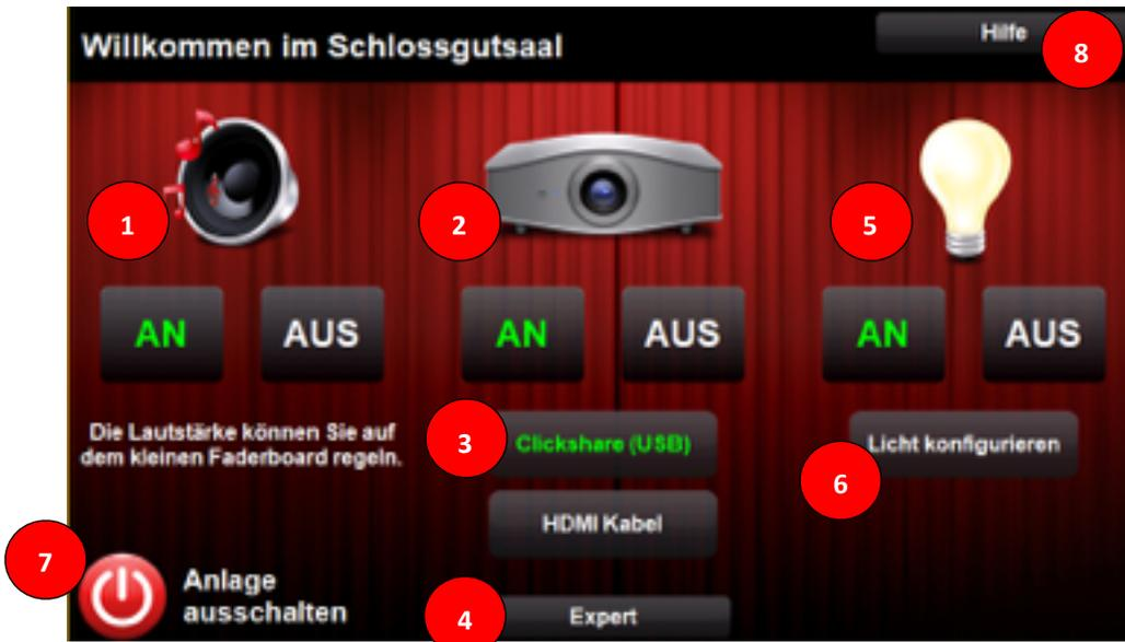
1. Sie können das Audio selbständig ein- und ausschalten. Es stehen 3 Funkstrecken zur Verfügung. Dabei kann pro Kanal jeweils ein Handsender oder ein Headset gewählt werden. Zudem ist bei der Bühne ein 3.5mm Klinke Anschluss vorhanden, mit dem das Audio von einem externen Gerät wie z.B. iPod oder Smartphone wiedergegeben werden kann. Für die Regulierung der Lautstärke steht hinter dem Vorhang ein kleines Faderpult zur Verfügung.
